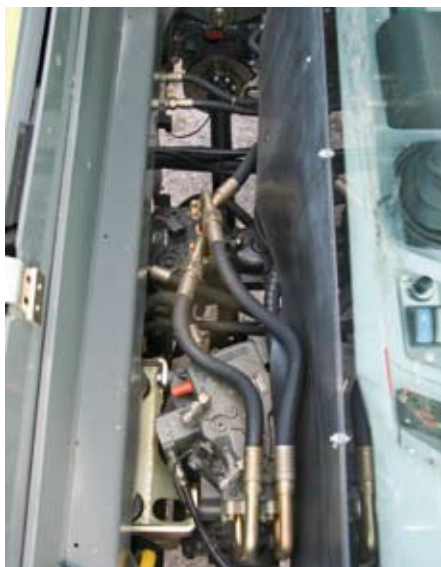
Der Antrieb ist unterhalb des Hubarms an den Motor geflanscht. Als Bremse dienen zwei Scheiben auf den Kardanwellen.
