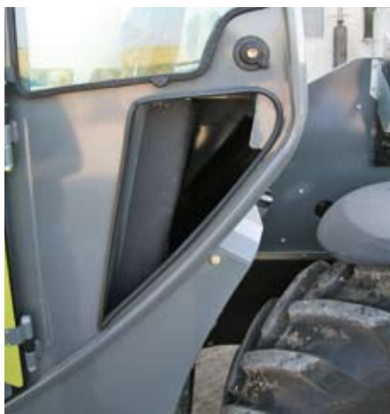
Hinten an der Kabine ist ein von außen zugängliches, kleines Staufach für Werkzeug oder Ähnliches angebracht.
