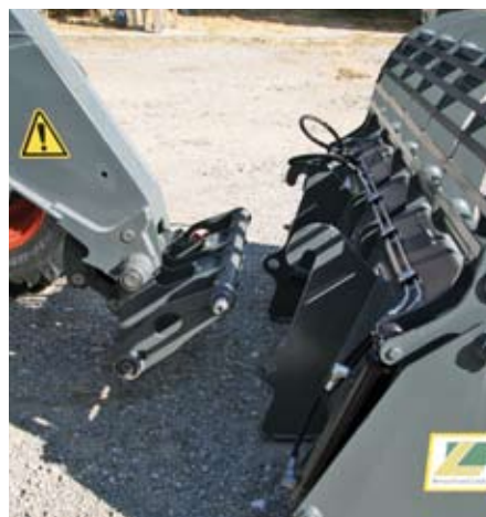
Die Werkzeugverriegelung erfolgt serienmäßig hydraulisch von der Kabine aus. So ist der Werkzeugwechsel schnell erledigt.
