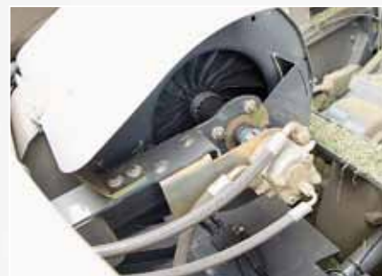
Das neue Reinigungsgebläse bringt laut Claas die 1,5-fache Luftmenge seines Vorgängers.
