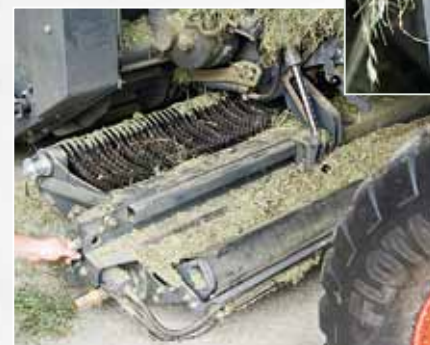
Das Absenken des Messerträgers erfolgt bequem von der Seite. Anschließend kann er – wie eine Schublade – zu etwa 60 % seitlich ausgezogen werden. So kann man den halben Messersatz bequem von links entnehmen, bevor man die Lade für den Rest zur anderen Seite durchschiebt.
