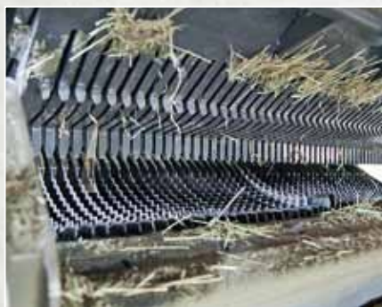
Messerboden und Messerträger sind jetzt getrennt. Bei einer Blockade senken sie nach wie vor gemeinsam ab (linkes Bild), zum Messerwechsel bleibt der Boden oben (rechtes Bild).
