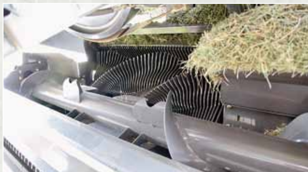
Die 2,35 m breite Pickup hat serienmäßig das „Power Feeding System“ (PFS) und einen Doppelrollen-Niederhalter. Die Zinken auf dem Schneidrotor sind spiralförmig angeordnet.
