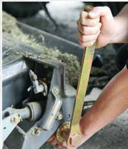
Messerboden und Messerträger sind jetzt getrennt. Bei einer Blockade senken sie nach wie vor gemeinsam ab (linkes Bild), zum Messerwechsel bleibt der Boden oben (rechtes Bild).
