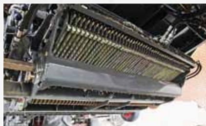
Die Messerschaltung kann bei der „FineCut“ in Gruppen von 12, 13, 26 und 51 Klingen vorgewählt werden. Bei der „RotoCut“ sind es 6, 12, 13 und 25 Messer. Die Klingen sind jetzt alle einzeln mit zwei Federn gesichert.
