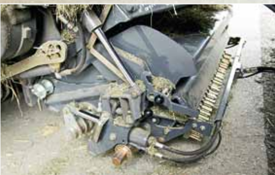
Messerboden und Messerträger sind jetzt getrennt. Bei einer Blockade senken sie nach wie vor gemeinsam ab (linkes Bild), zum Messerwechsel bleibt der Boden oben (rechtes Bild).
