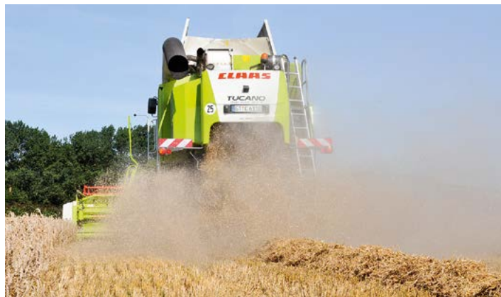
Von bis: Der große Einzelrotor zerreibt das Stroh etwas weniger als die zwei Lexion-Rotoren. Und bei niedriger Rotordrehzahl erreicht der Tucano-Hybrid fast Schüttlerqualität.
