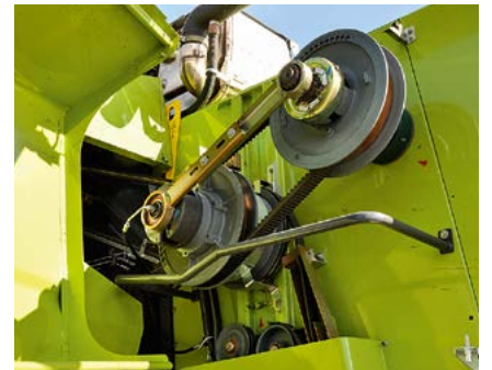
Der Rotor lässt sich dank Variatorantrieb stufenlos von 480 bis 920 U/min verstellen und an die Erntebedingungen anpassen.
